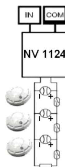
шлейф пожарных двухпроводных извещателей
